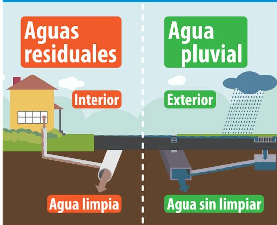
En Springfield, el sistema de agua pluvial es independiente del sistema de aguas residuales.
